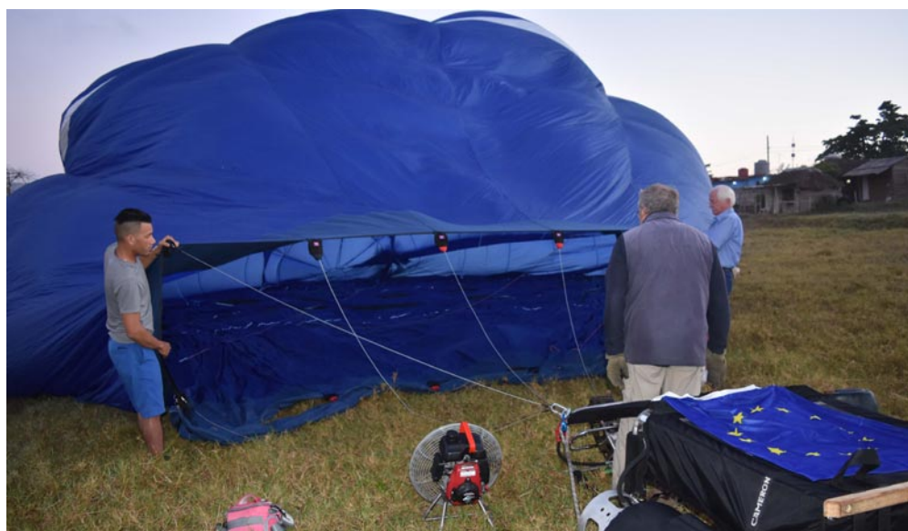
El llenado en frío de la vela lo realizan con un ventilador
